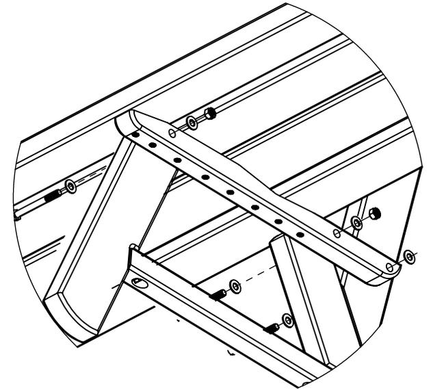
NOTE: BE SURE SPACING BETWEEN SEAT LEG ASSEMBLY A & B IS THE SAME AS THE SPACING AS B & C.
